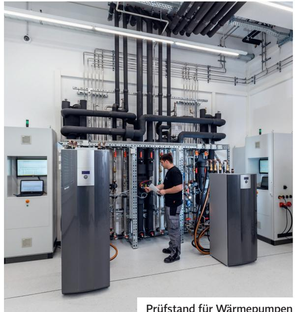
Prüfstand für Wärmepumpen
